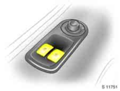
Elektrik kumandalı camlar ❄ Sürücü kapısındaki cam, kontak açık konumdayken kapı içindeki kumanda düğme kullanılarak çalıştırılır.
